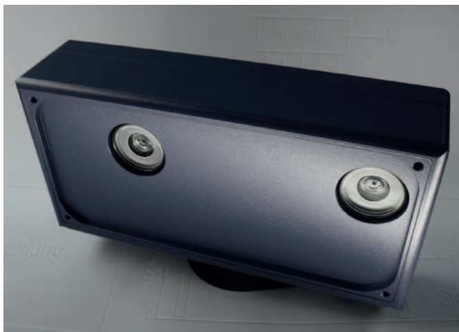
People Counter: Stereokamerabasiertes bidirektionales Personenzählgerät.
