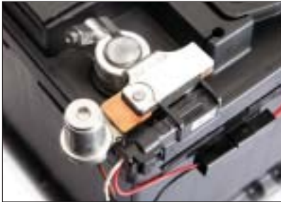
Montage am Standard-Batterie-Pol (Batteriepoladapter nicht im Lieferumfang enthalten).
