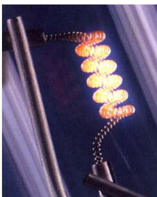
Afb. 2 H7 standaardlamp met conventionele dubbele gloeidraad.
