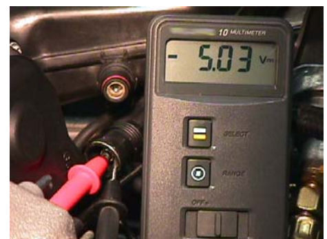
Spanningsverzorging op de sensor
