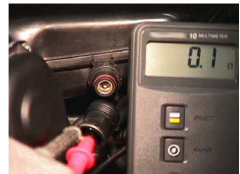
Resistenza del cavo tra il connettore del sensore e il connettore della centralina
