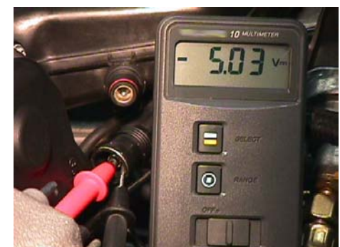
Alimentazione elettrica sul sensore
