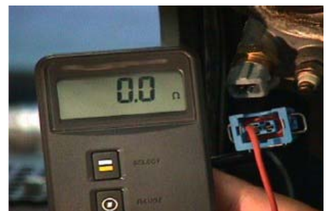
Resistenza del cavo tra il connettore del sensore e il connettore della centralina
