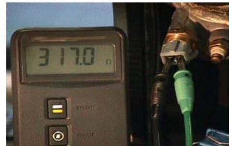
Misurazione della resistenza a motore caldo
