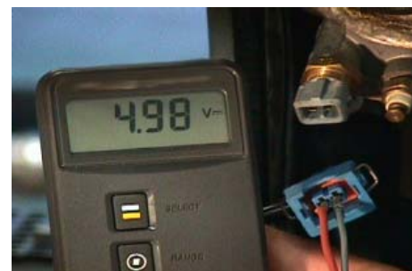
Alimentazione elettrica sul connettore del sensore
