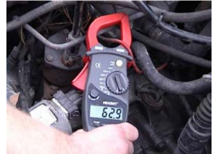
Misurazione dell'assorbimento di corrente
