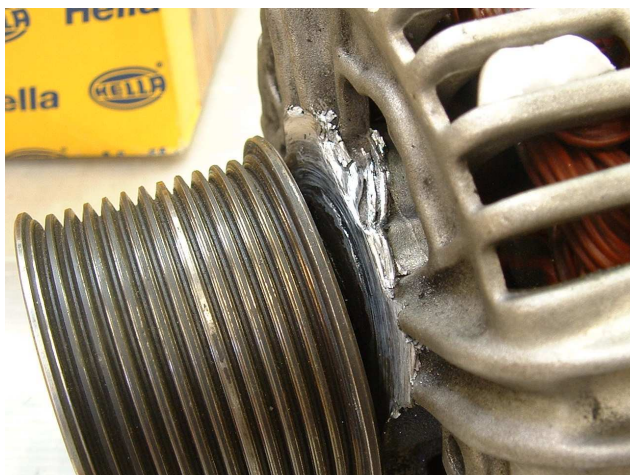
Carcassa dell'alternatore danneggiata a causa di cuscinetti usurati
