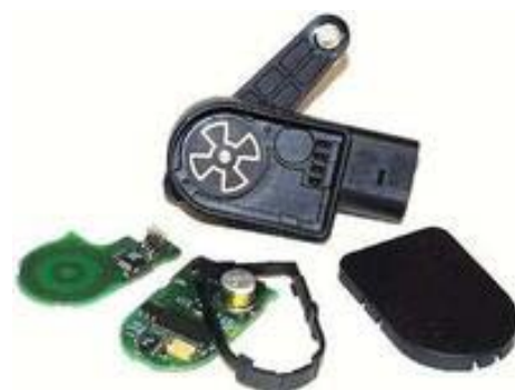
Appareil de commande de la portée, intégré dans le capteur.
