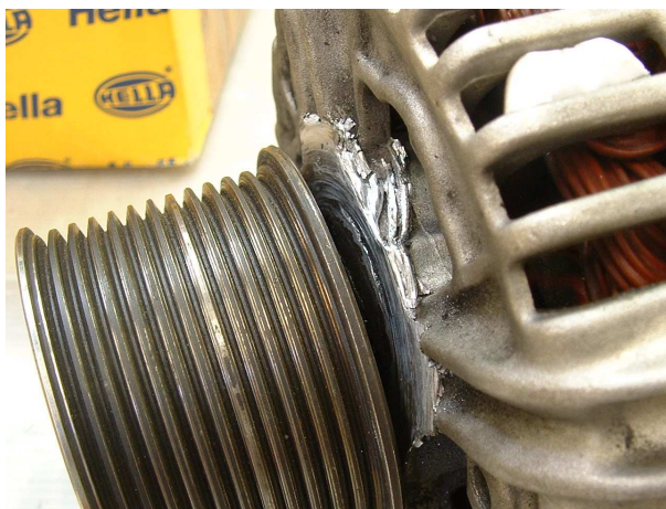
Boîtier d'alternateur endommagé par un palier usé
