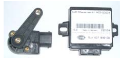
Sensor del eje inductivo con unidad de control externa
