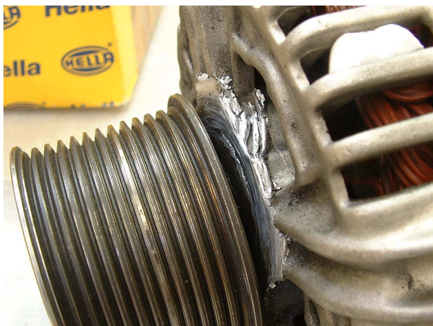
Carcasa del generador dañada debido a un cojinete desgastado
