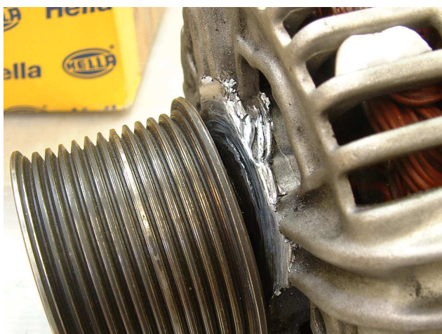
Beschädigtes Generatorgehäuse durch verschlissenes Lager
