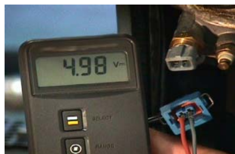
Spændingsforsyning til sensorstik.
