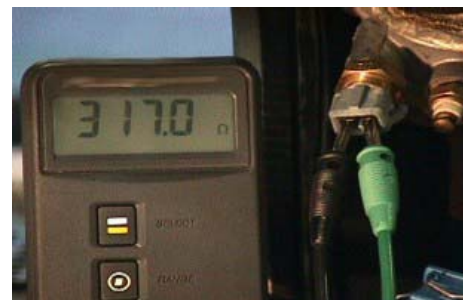
Modstandsmåling med varm motor.
