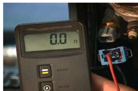
Modstandsmåling i ledninger fra sensorstik til styreenhedsstik.
