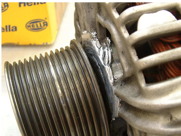
Beskadiget generatorhus pga. slidt leje
