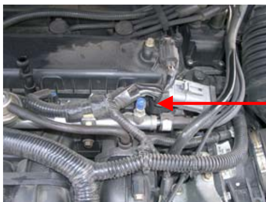
Przyłączenie do kontroli ciśnienia paliwa
