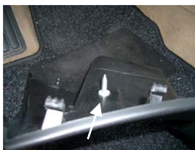
Śruba mocująca z podkładką z tworzywa
