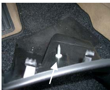
Vis avec rondelle en plastique Figure 2
