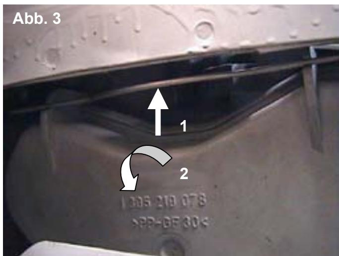
8. Nach dem Glühlampenwechsel die Arbeitsschritte in umgekehrter Reihenfolge durchführen
