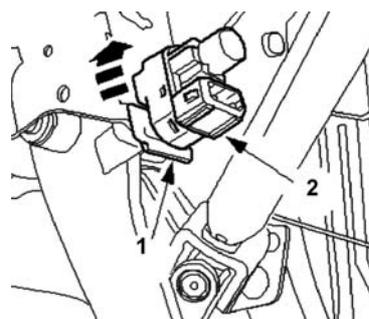
Neuen Schalter einbauen und Nullstellung des Kontaktstiftes bis zum Anschlag am Bremspedal justieren:
