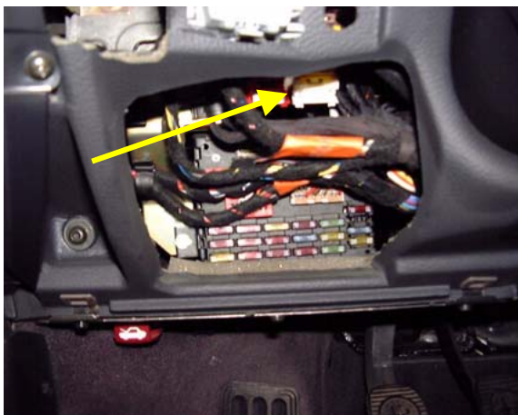
Bild 1: ABS-Sicherung: Unterhalb dem Armaturenbrett, links neben der Lenksäule (LHD)
