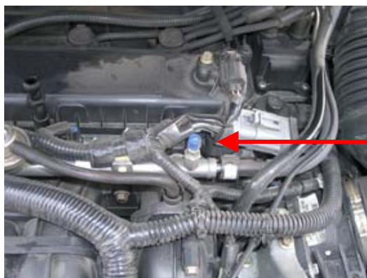
Prüfanschluss für den Kraftstoffdruck
