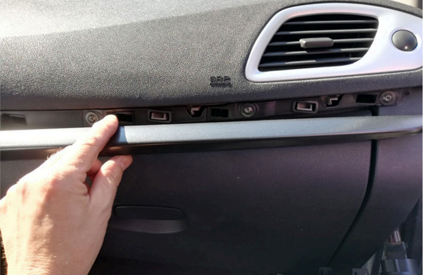
Torpedo gözünün sa##ndaki kapa## kald#r#n
