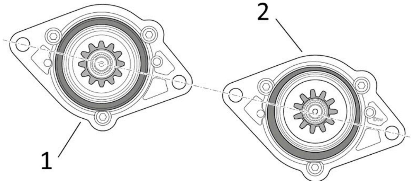
Motores de partida com posição de pinhão central (1) e posição de pinhão deslocada (2)
