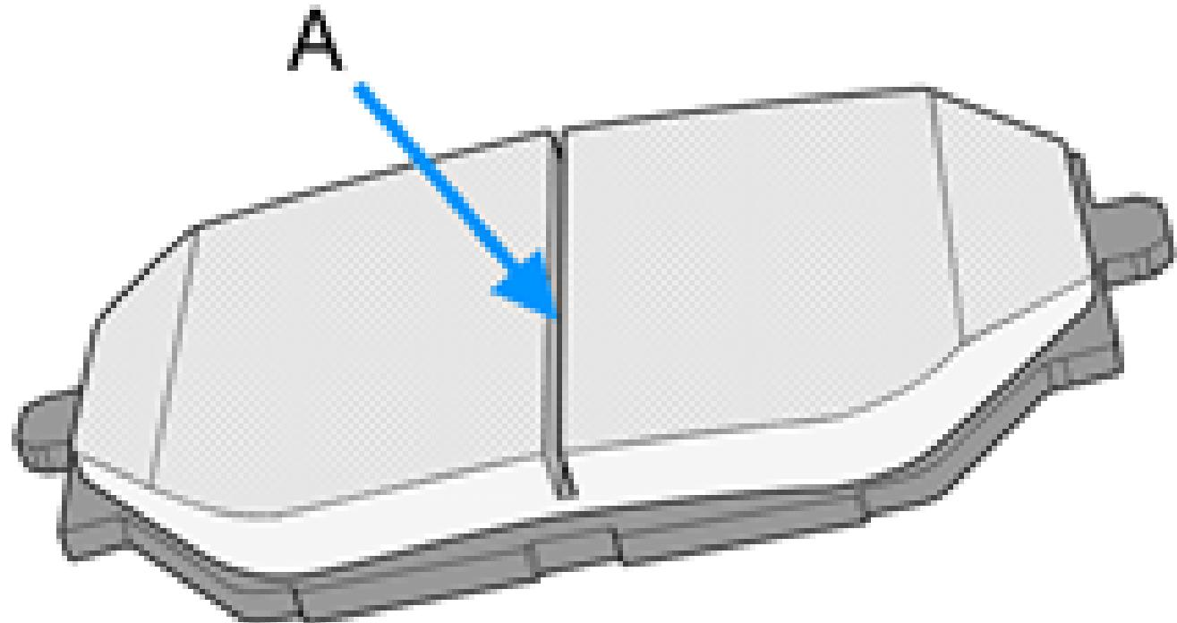
Nos modelos de veículo supracitados podem ocorrer vibrações de ressonância a velocidades de marcha constantes entre 65 -125 km/h, as quais podem provocar ruídos incómodos no eixo dianteiro. Este problema pode ter origem no calço do travão ou pode dever-se à parte construtiva do travão de roda, em combinação com uma jante de 15 polegadas.
