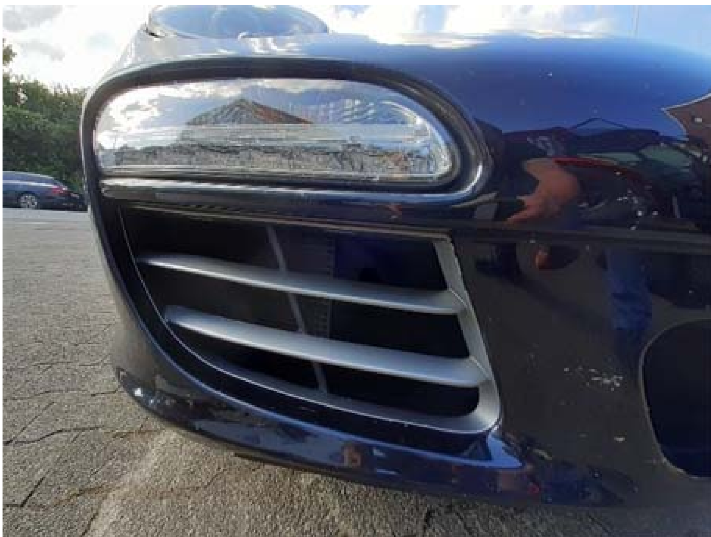
Figura 1: os radiadores estão localizados à esquerda e direita, atrás da grelha do radiador, no para-choques.
