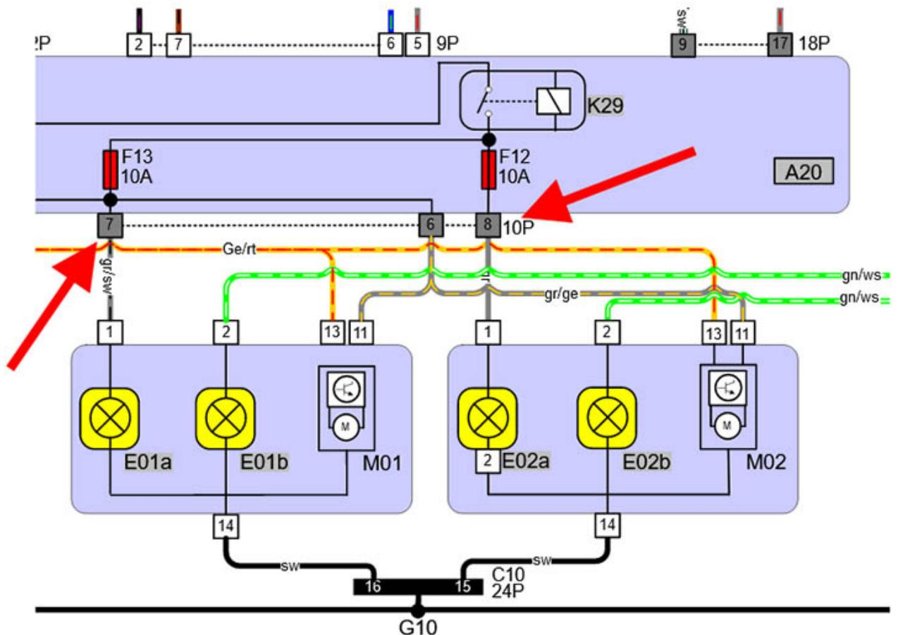
Conexão de ficha no módulo de comando da rede de bordo (A20). Luz de médios esquerda (E01a) Luz de médios direita (E02a)
