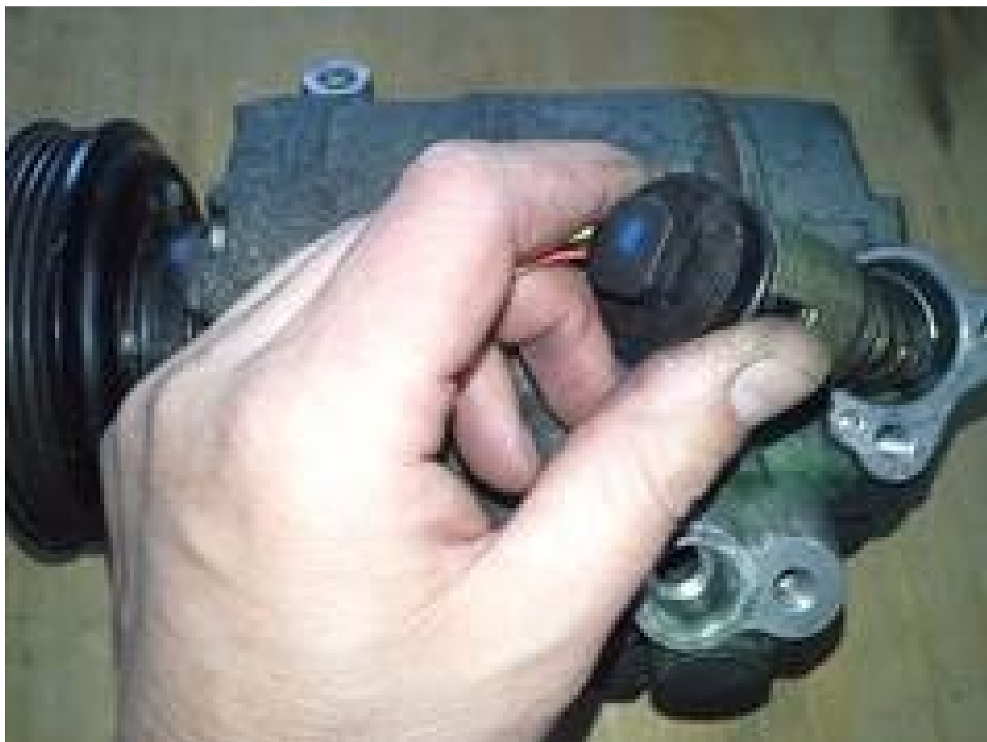
Na figura, é exibido o exemplo de um compressor com válvula de regulação da pressão eletrónica
