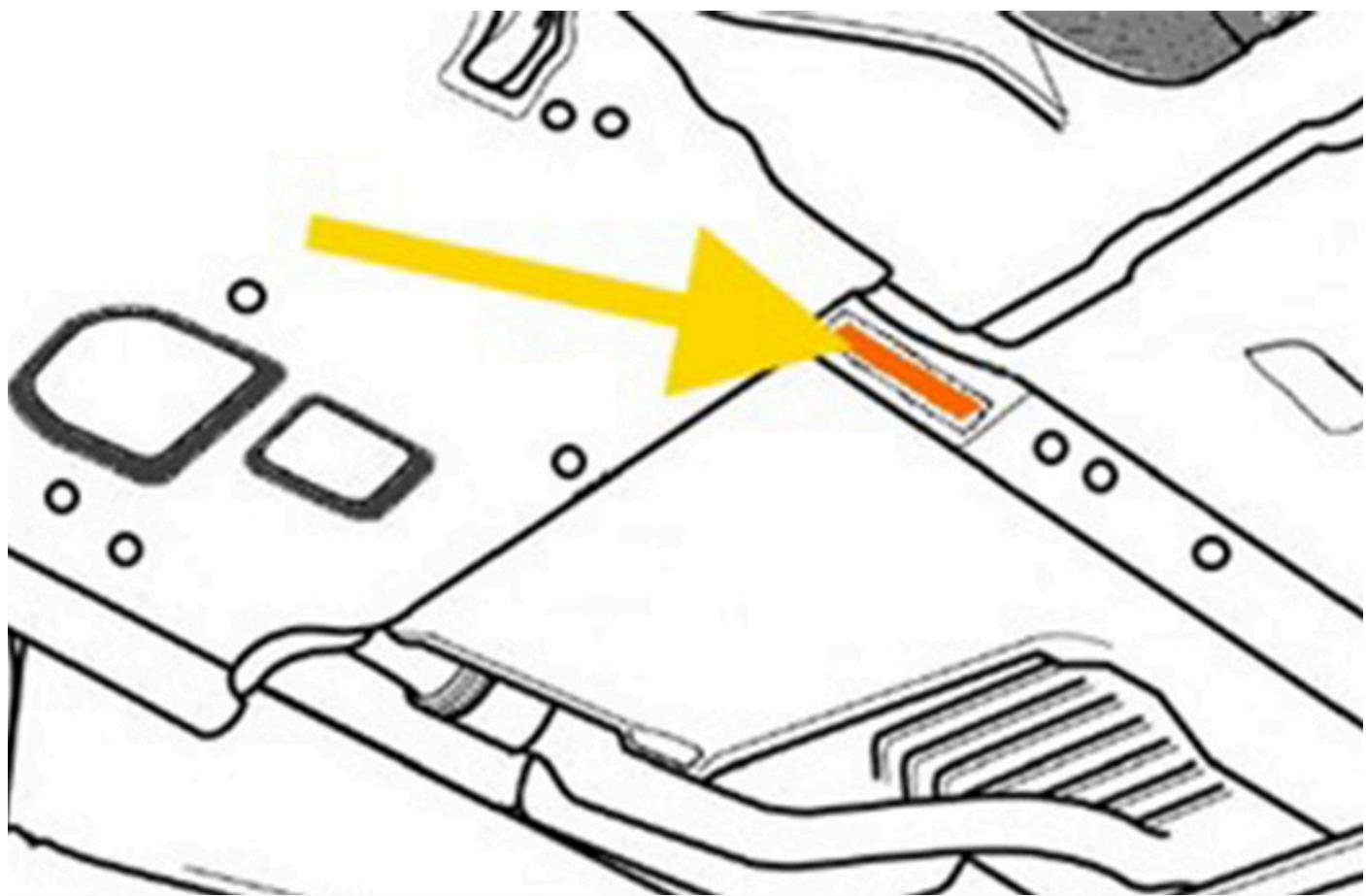
Limpar minuciosamente a área assinalada na figura e montar o apoio de espuma (n.º OE 16111181918) de acordo com as especificações do fabricante automóvel.
