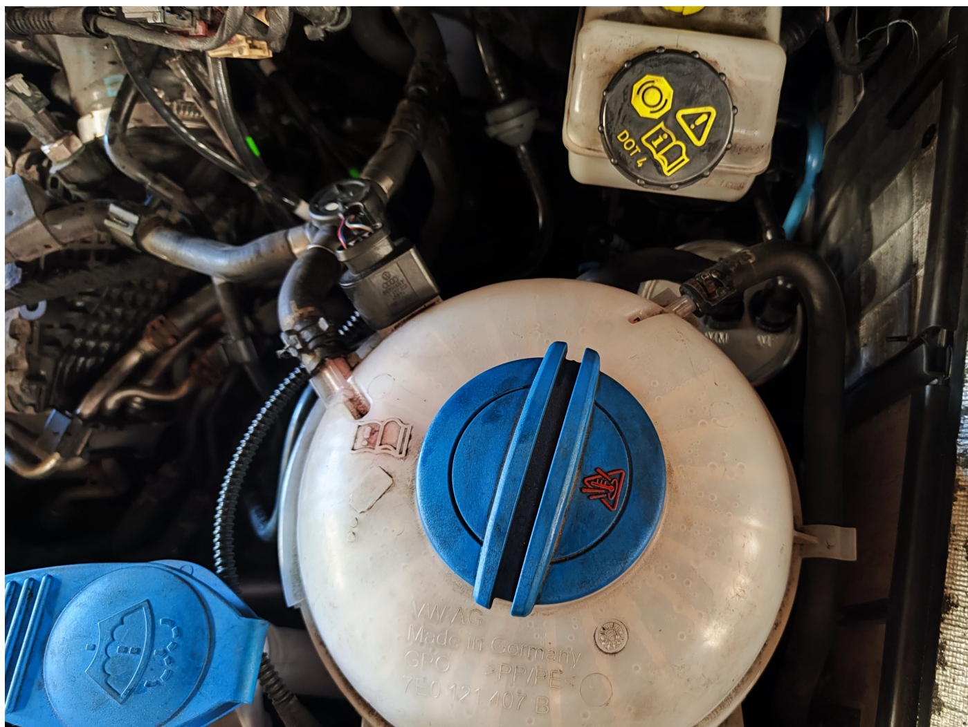
Reservatório de compensação T6
