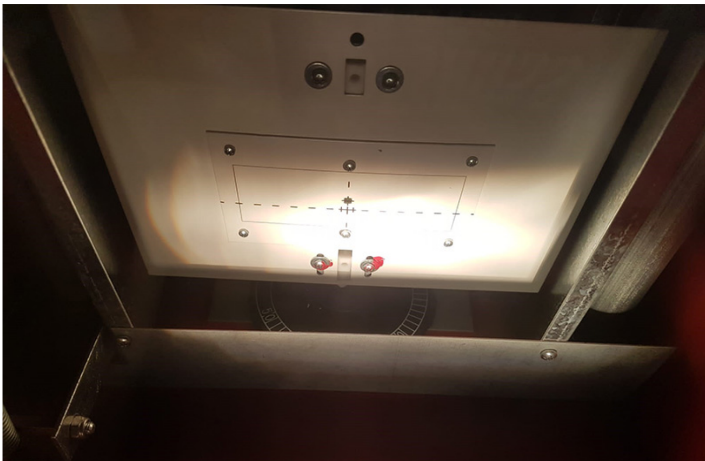
Figura 1: dispersão descontrolada dos feixes de luz
