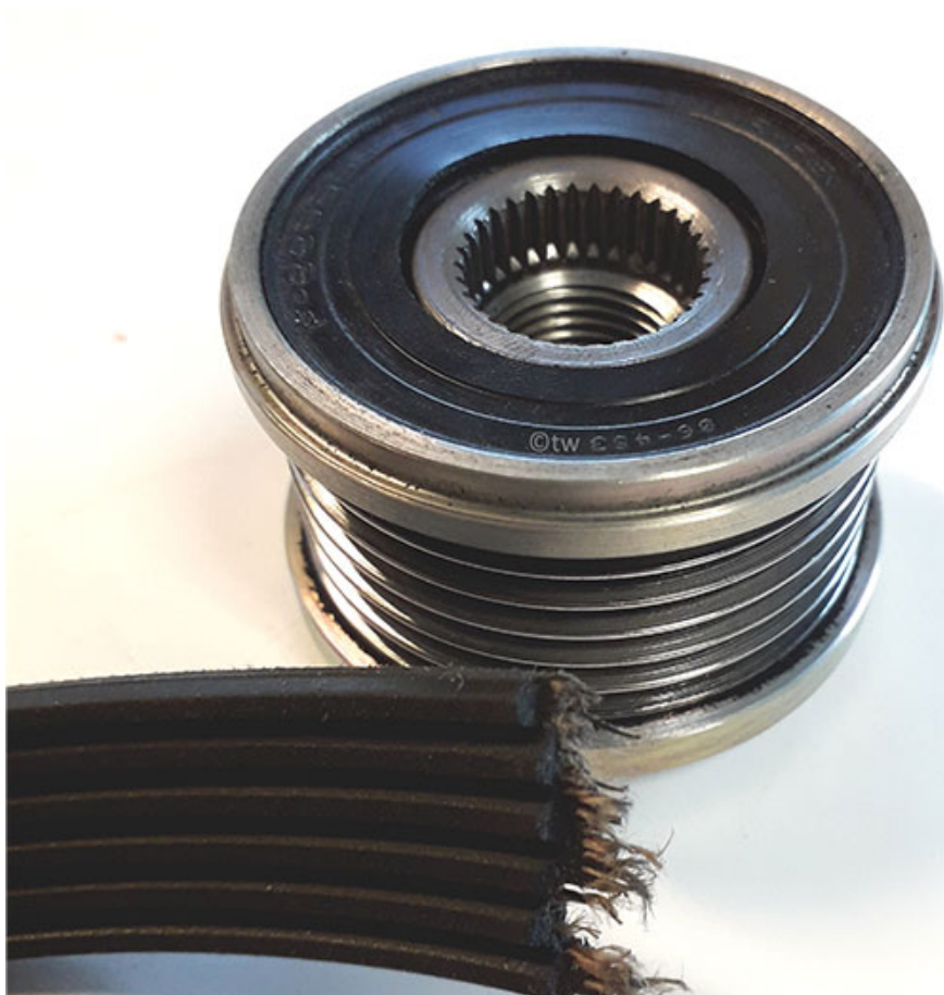
Polia de roda livre com defeito com rutura da correia trapezoidal
