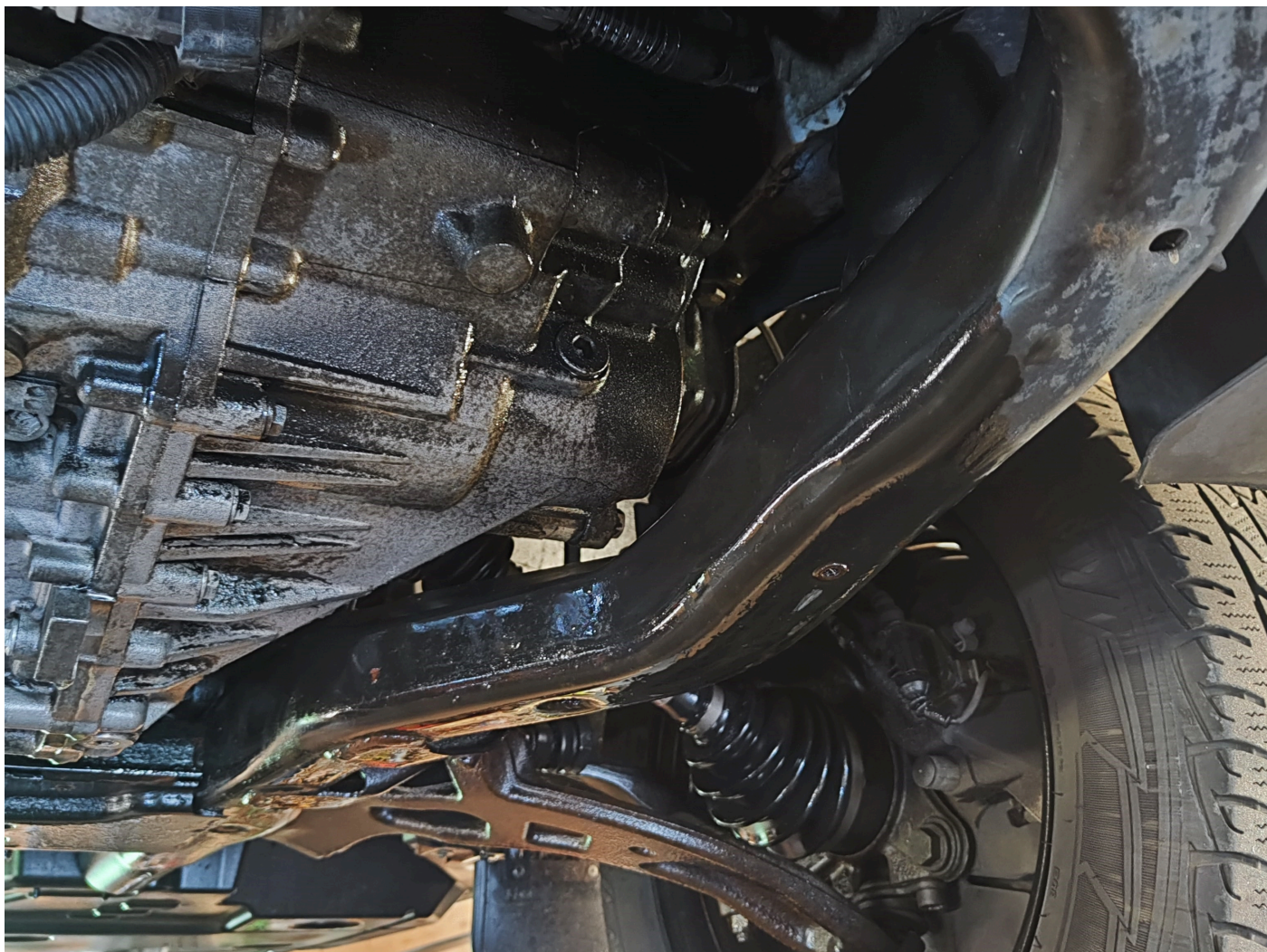
Wyciek paliwa T6
