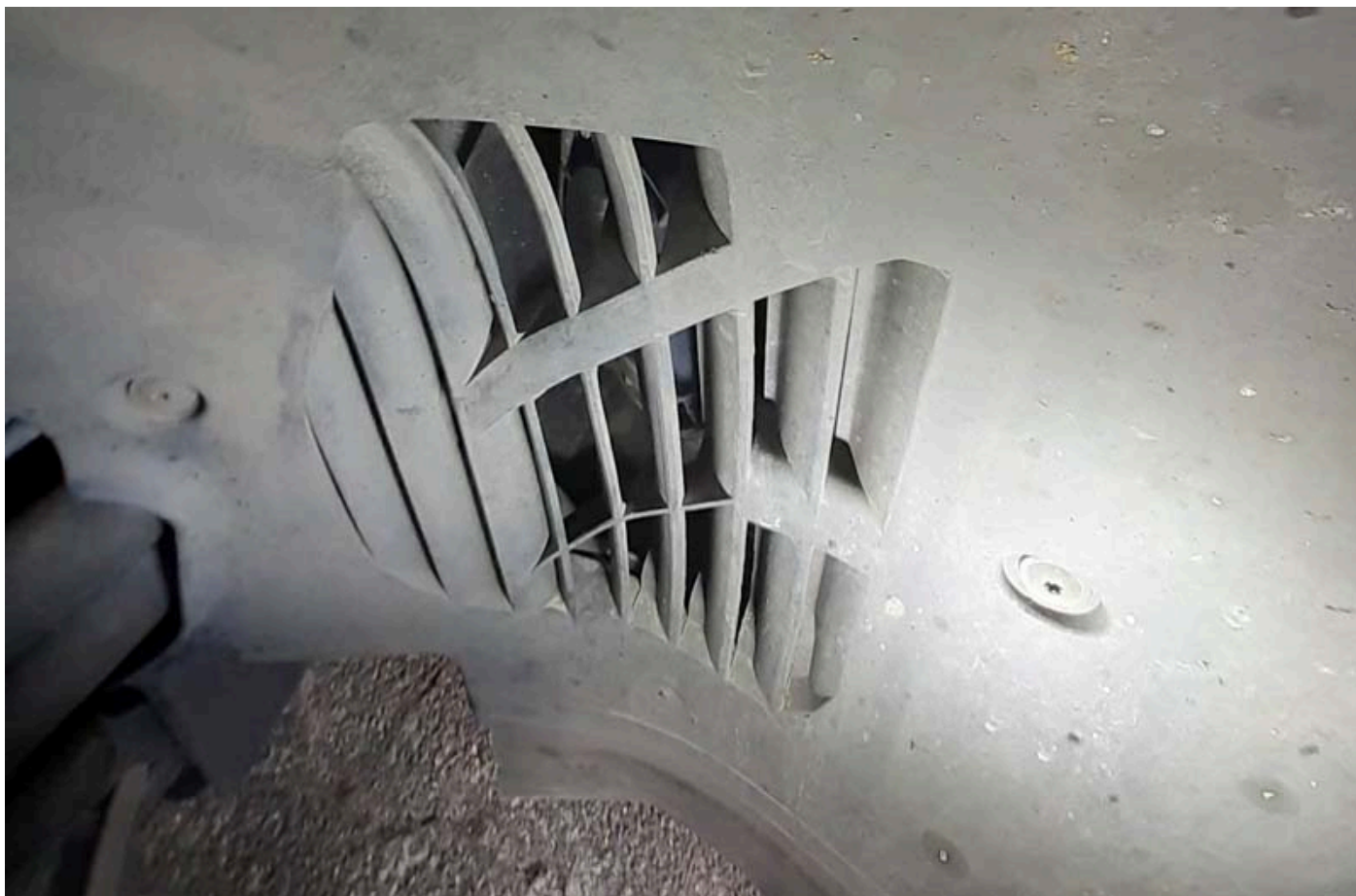
Zdjęcie 2: Dostęp do wentylatorów jest możliwy od strony nadkola po uprzednim zdjęciu wewnętrznej osłony.
