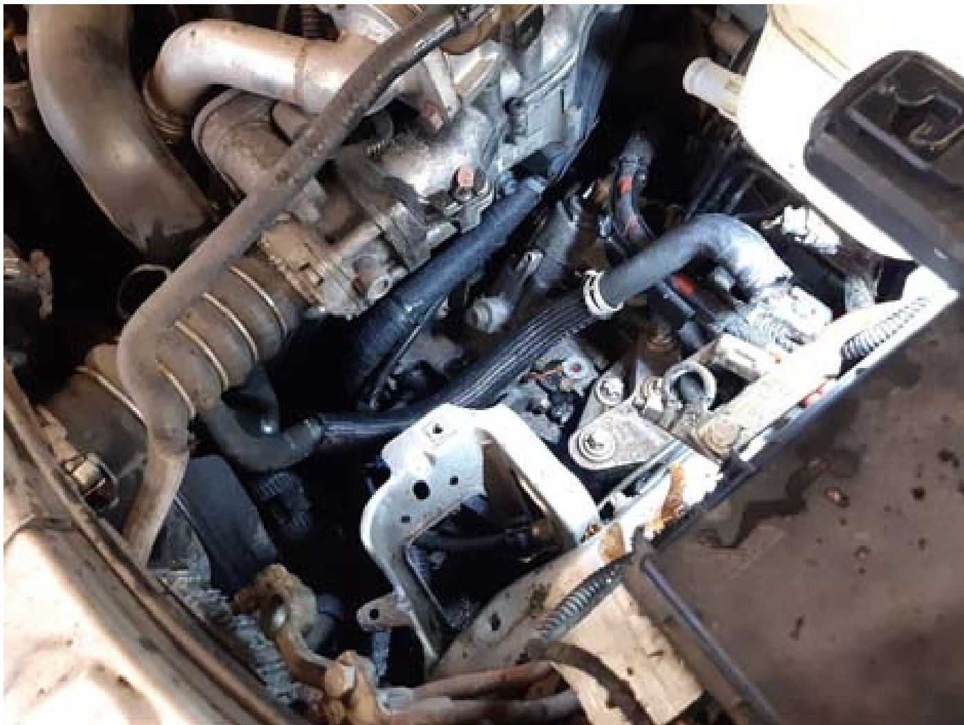
Zdjęcie 1: Wyjęcie akumulatora i jego uchwytu
