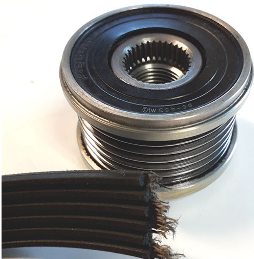
Uszkodzone koło pasowe z pękniętym paskiem klinowym
