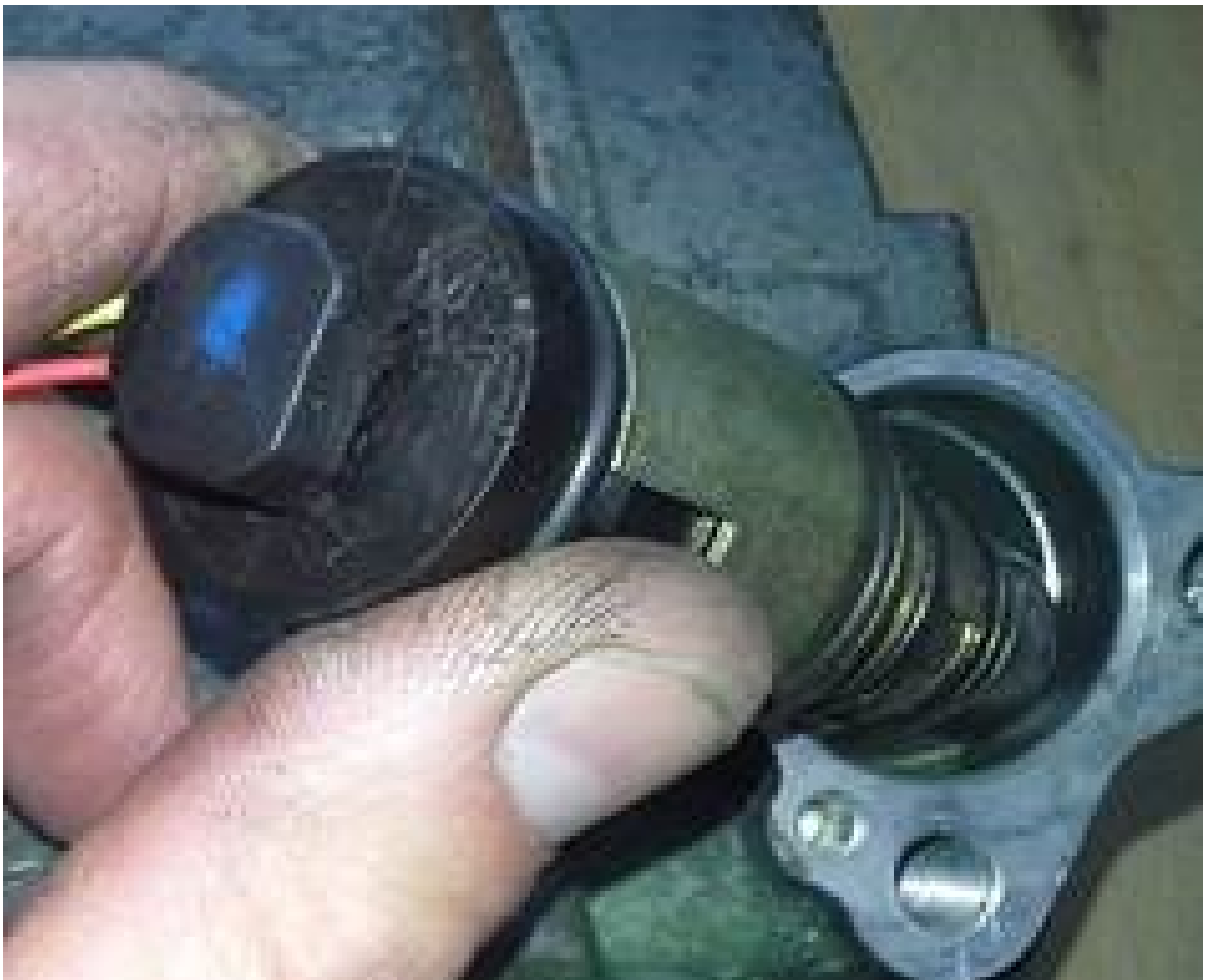
Bild zeigt beispielhaft ein elektronisch geregeltes Druckregelventil
