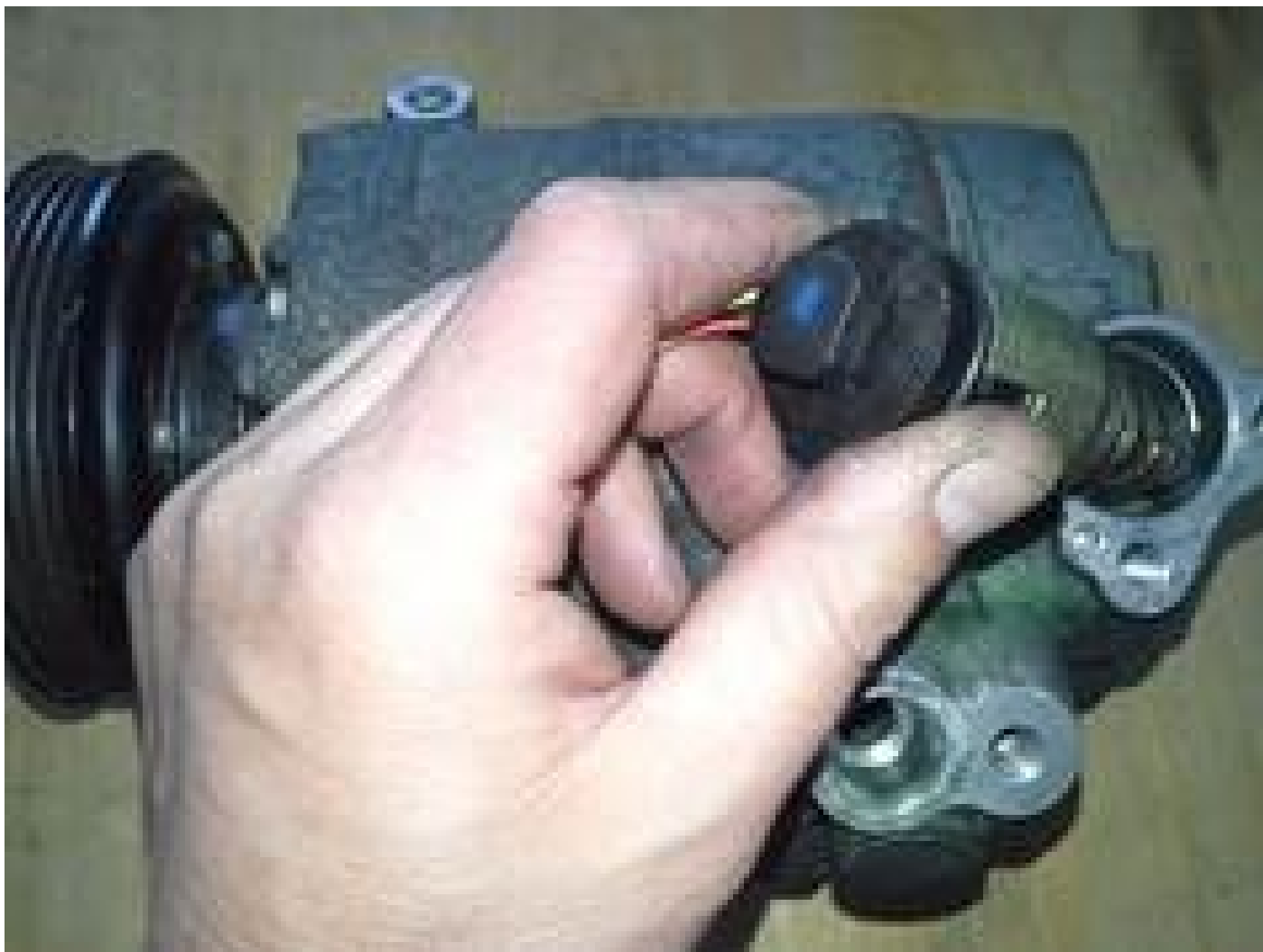
Bild zeigt beispielhaft Kompressor mit elektronisch geregelter Druckregelventil
