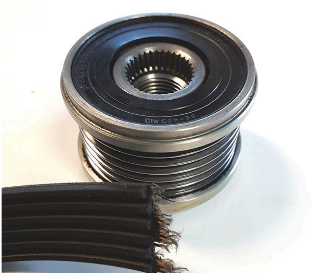
Defecte vrijlooppoelie met gebroken multi-V-riem
