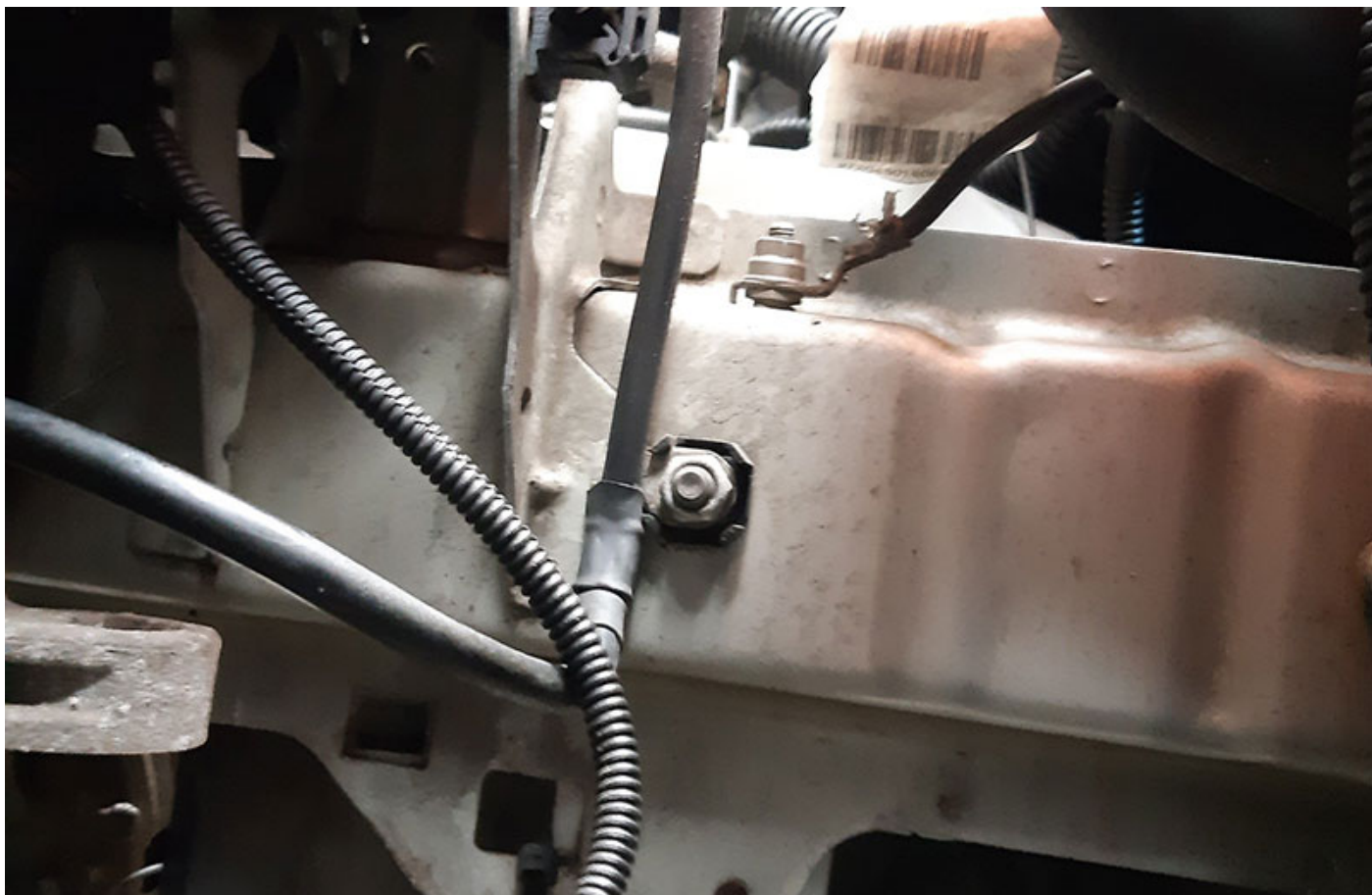
Fiat Grande Punto - Motor start niet: Aardverbinding controleren
