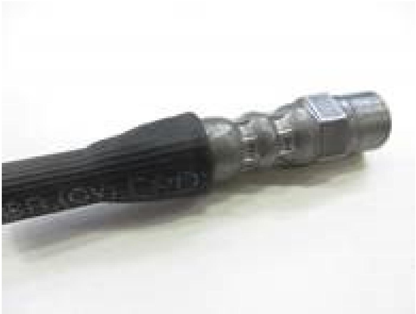
**Formación de grietas en la cubierta de la manguera**
