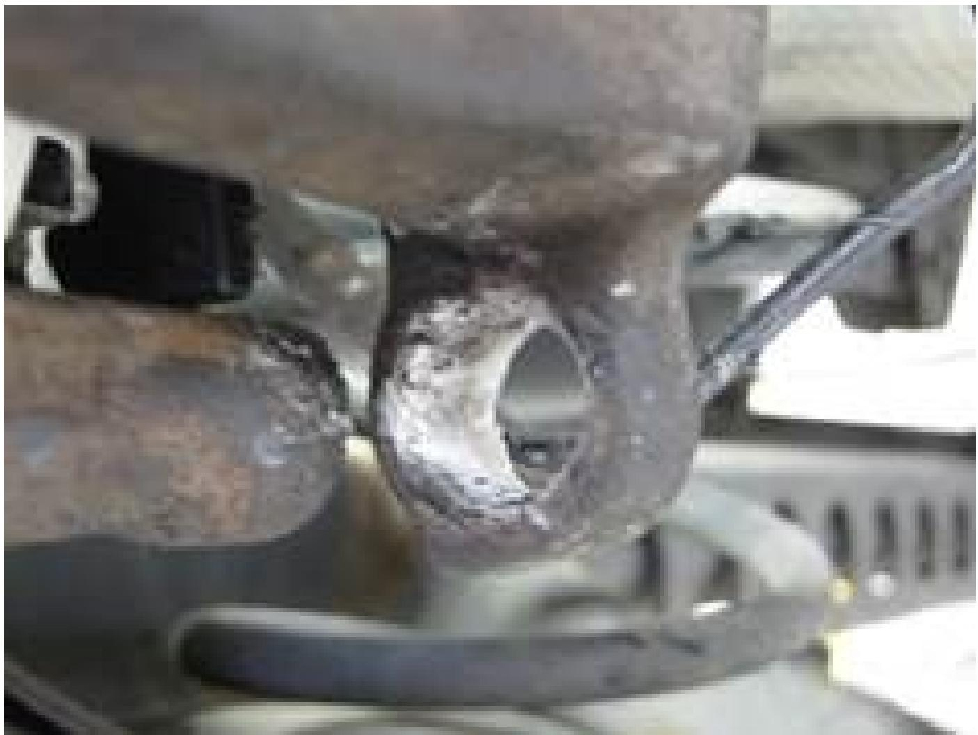
**Para ello, utilice una herramienta escariadora adecuada con el fin de reparar los orificios de modo uniforme. Al realizar esta reparación quizá sea necesario sustituir los manguitos de suspensión y los pernos guía.**
