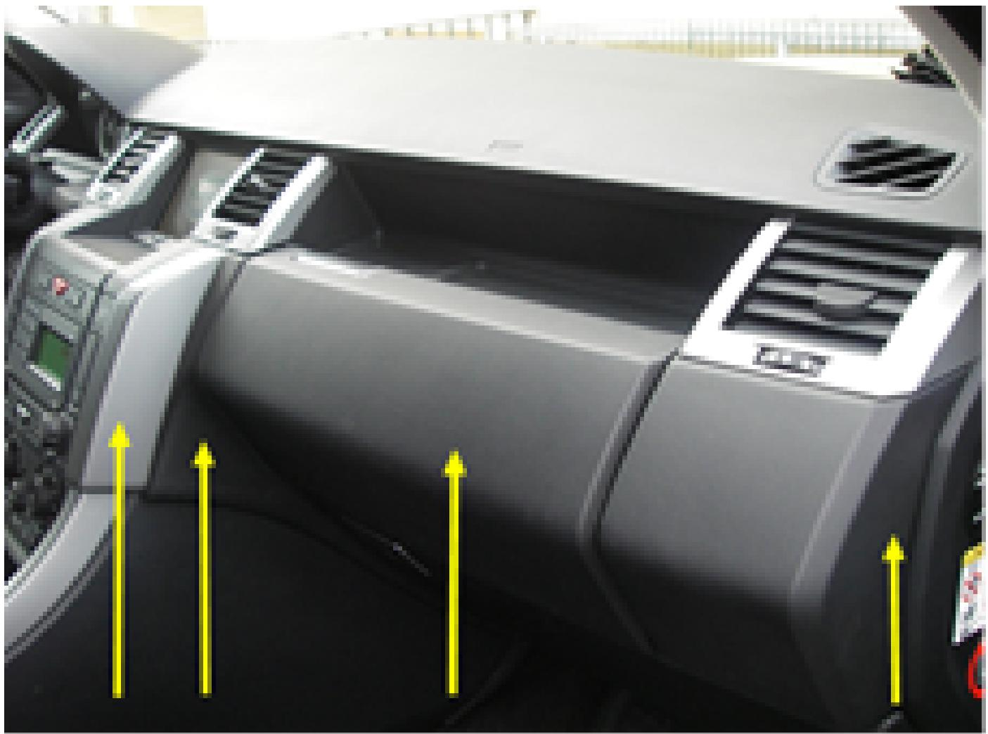
Si en el Range Rover Sport (modelos mencionados) aparecieran ruidos, como silbidos o pitidos en la zona del tablero de instrumentos, sería difícil indicar una causa exacta, pero la causa más probable es que se haya formado suciedad entre las varillas de la válvula de ventilación. Estos ruidos pueden agudizarse si en el aire acondicionado se conecta la función de ventilación.
