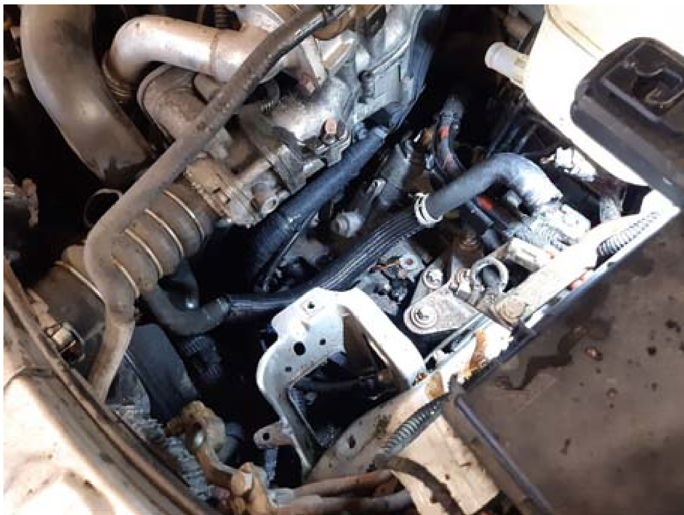
Fig. 1: Desmontar la batería y el soporte de la batería
