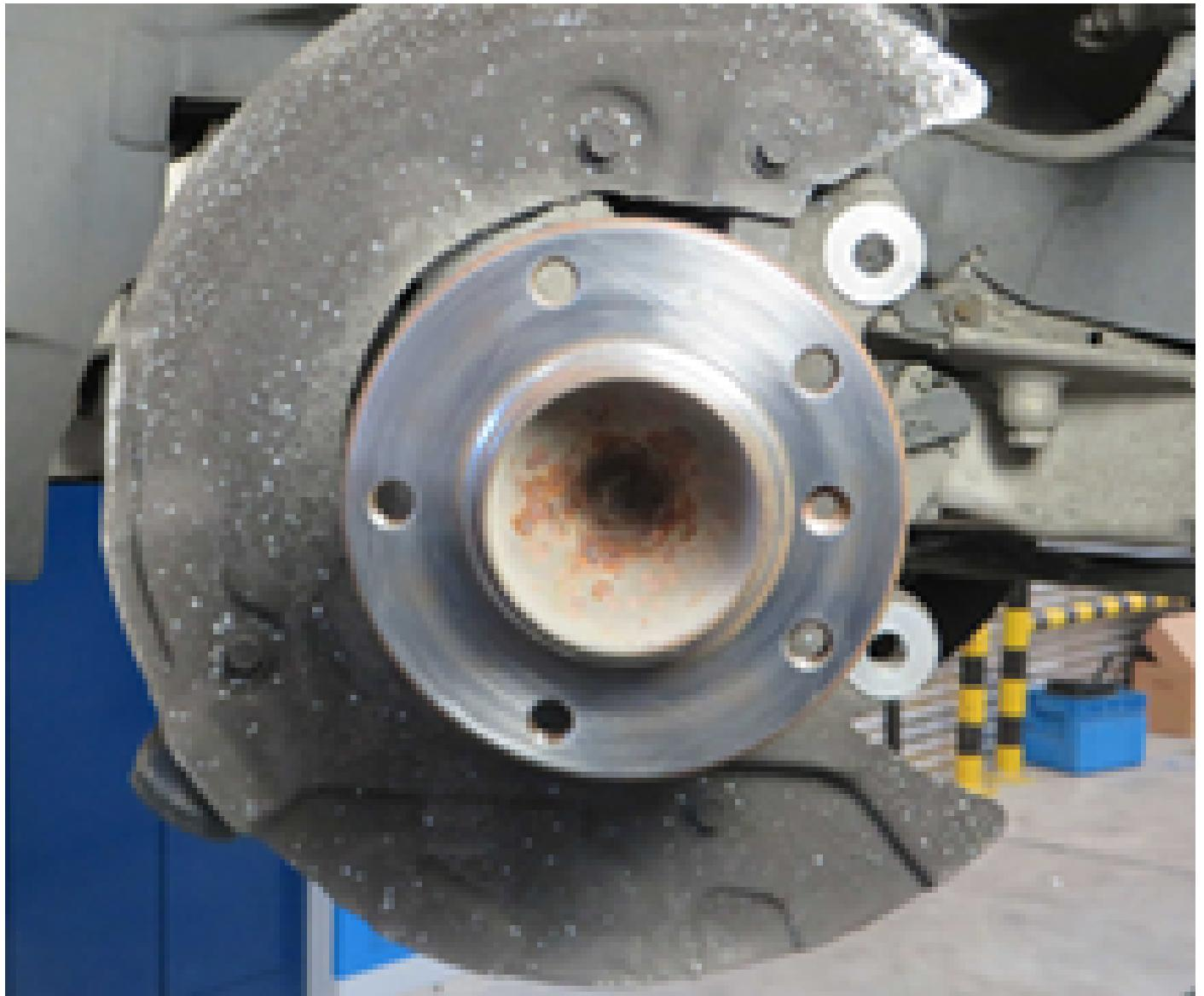
Montare il disco freno e fissare con una vite di fissaggio.
