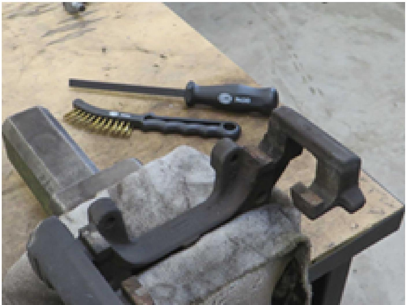
Montare il supporto della pinza freno
