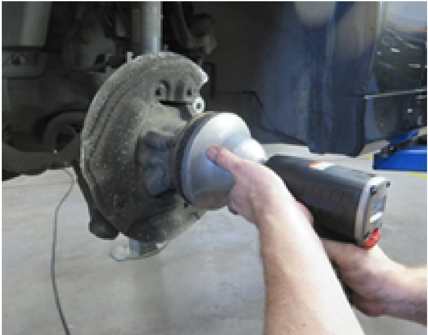
La superficie di appoggio del mozzo della ruota deve essere in metallo lucido pulito e non deve apparire danneggiata né arrugginita. Per proteggere la superficie di appoggio dalla corrosione, nebulizzare leggermente con olio lubrificante e asciugare con un panno privo di pelucchi.
