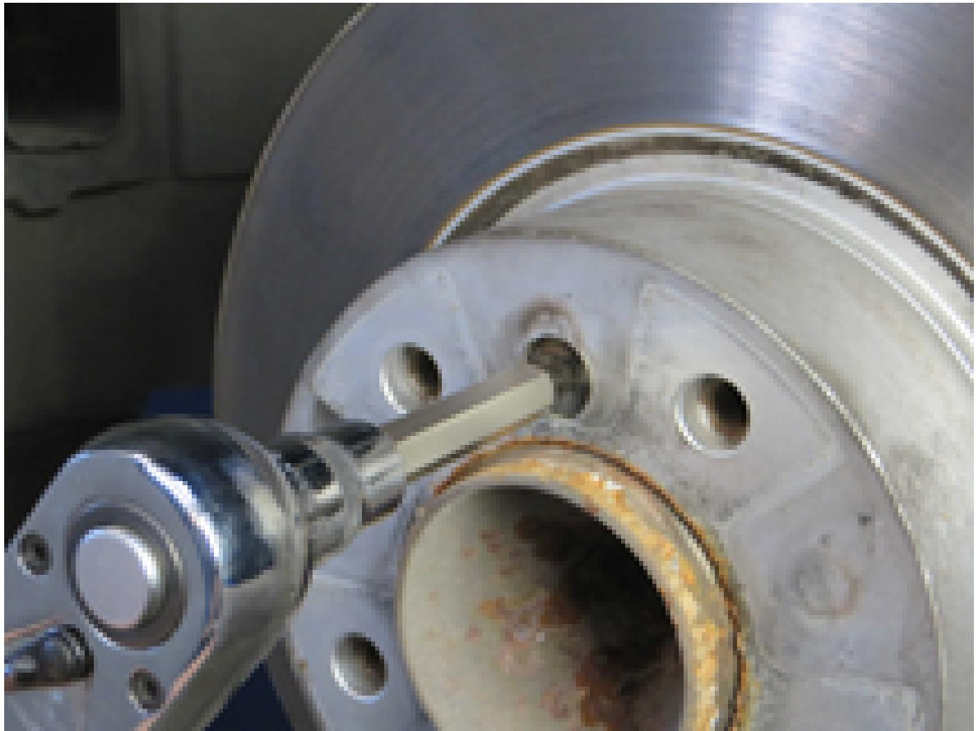
Preparare il supporto della pinza freno per il montaggio.
