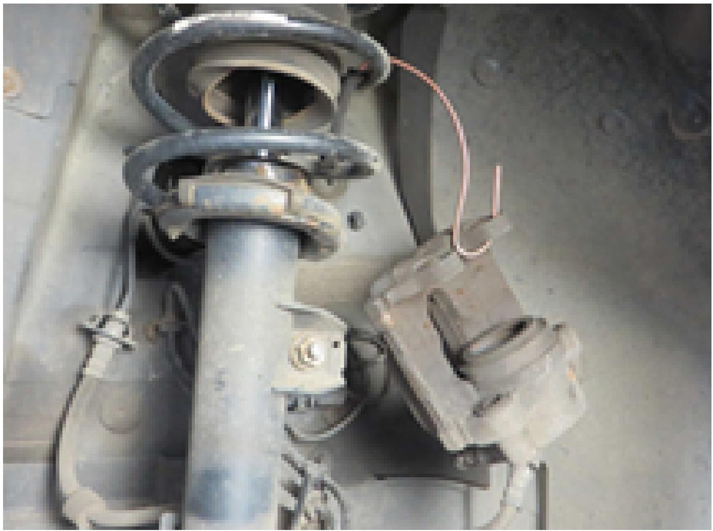
Rimuovere svitandole entrambe le viti di fissaggio del supporto della pinza freno.
