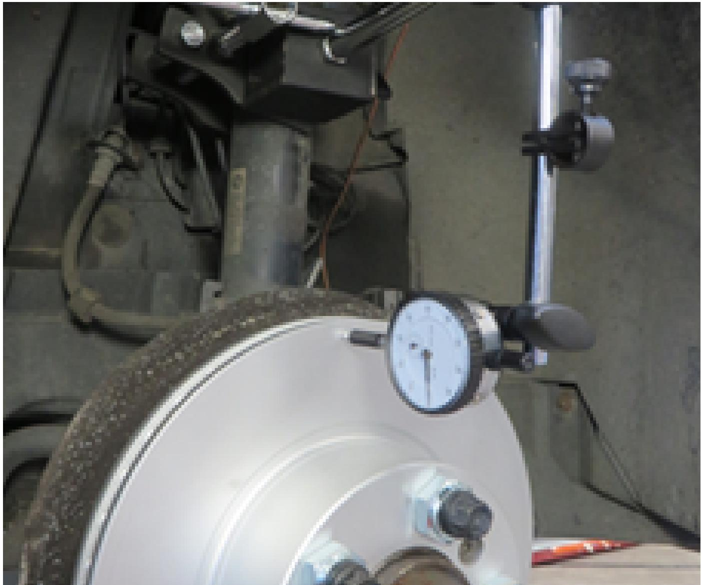
**Questo controllo risulta preciso solo se viene effettuato su dischi freno nuovi o come nuovi. In caso di scostamenti occorre considerare le condizioni del mozzo della ruota e del cuscinetto come ulteriori possibili cause di guasto.**
