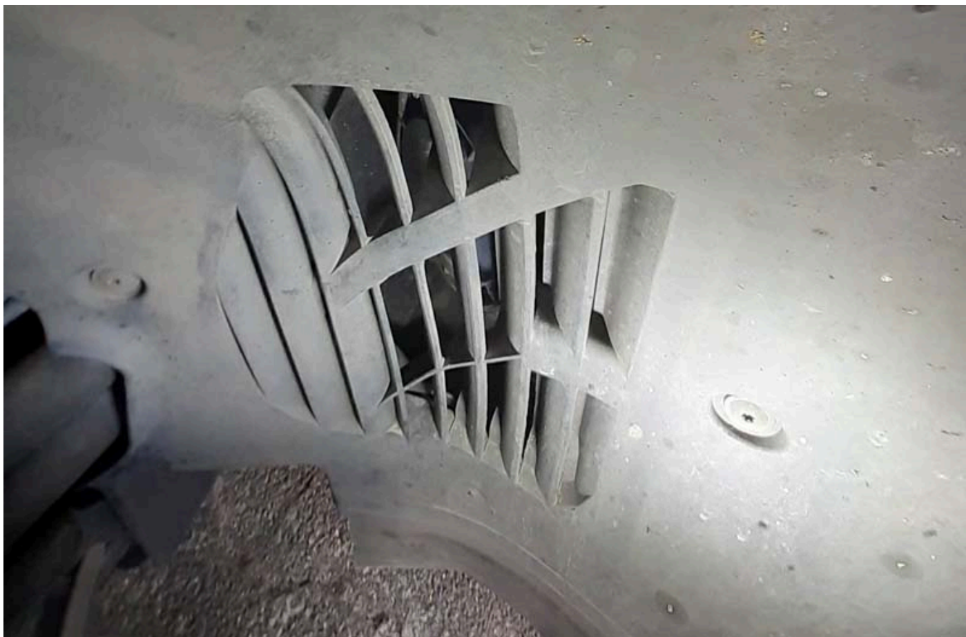
Figura 2: Le ventole sono accessibili rispettivamente dal passaruota smontando il relativo rivestimento.
