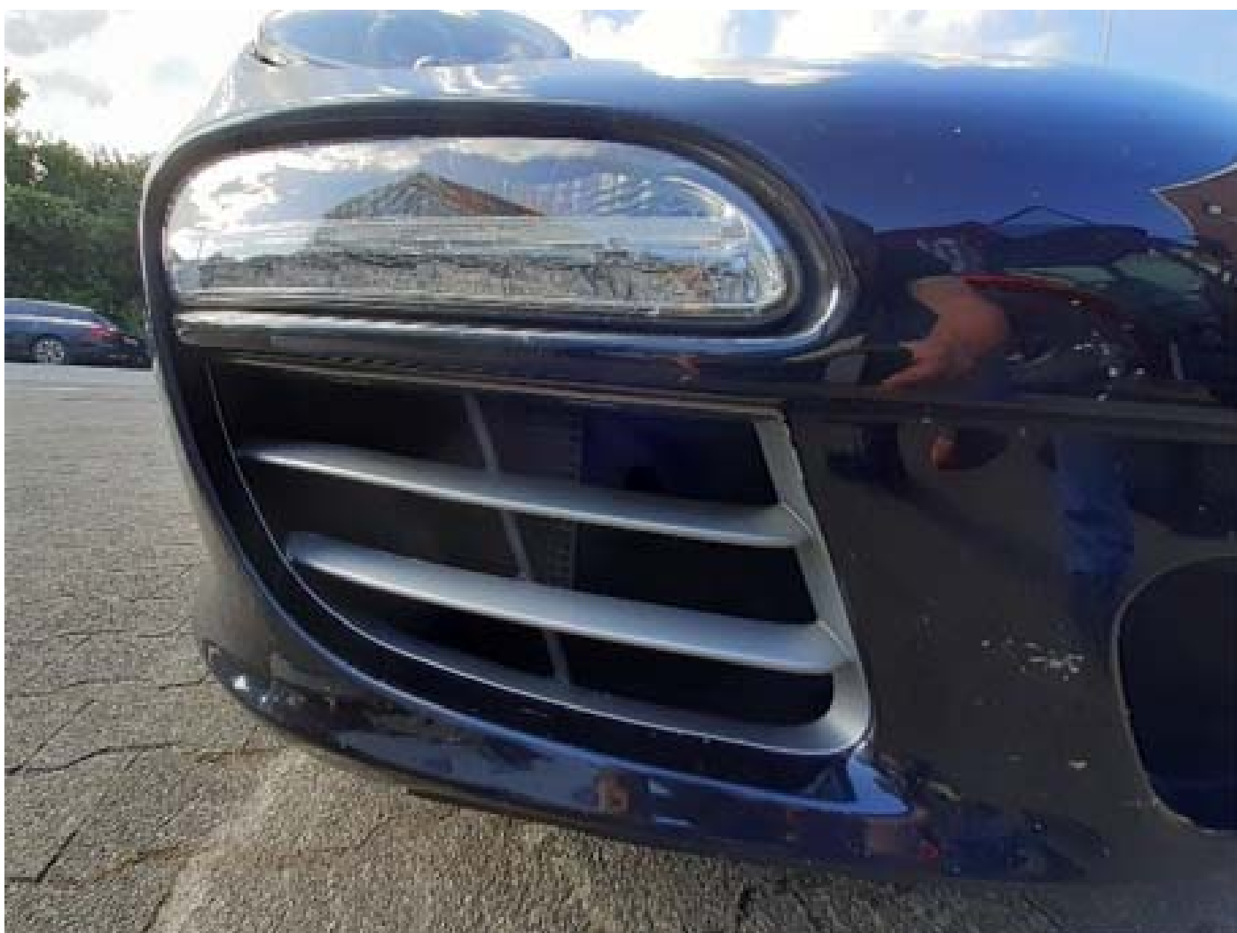
Figura 1: I radiatori si trovano rispettivamente a sinistra e a destra dietro la mascherina del deflettore dell'aria, nel paraurti.
