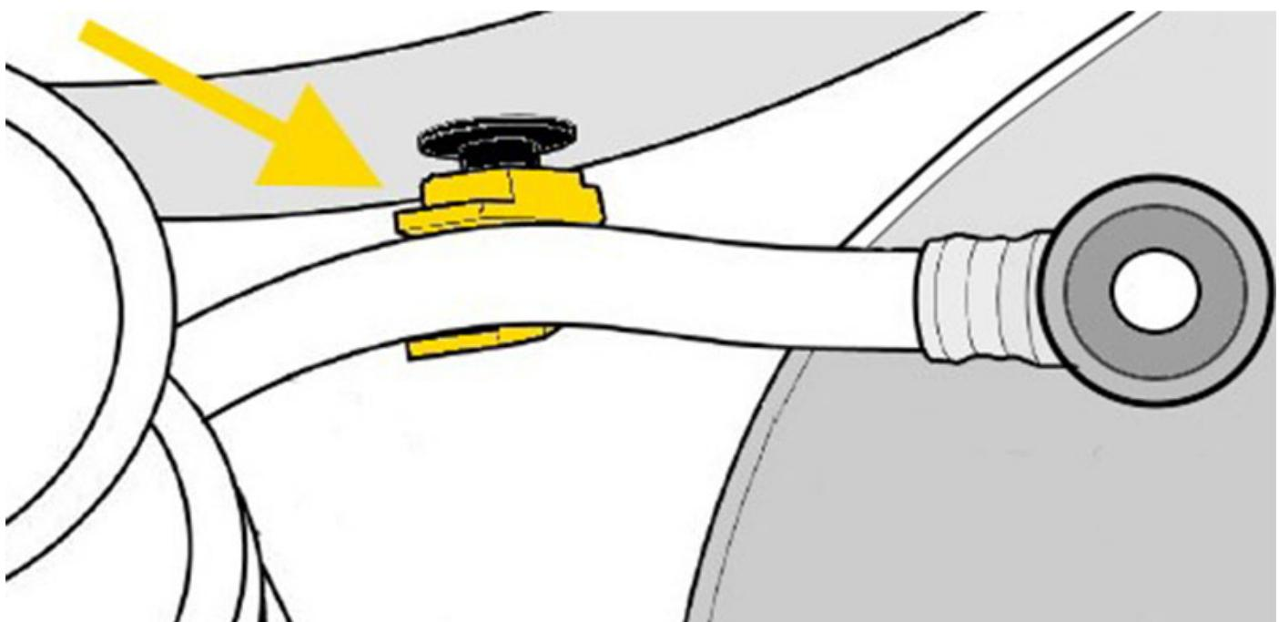
Fissaggio insufficiente della linea del vuoto del servofreno a causa di una staffa di fissaggio difettosa.
