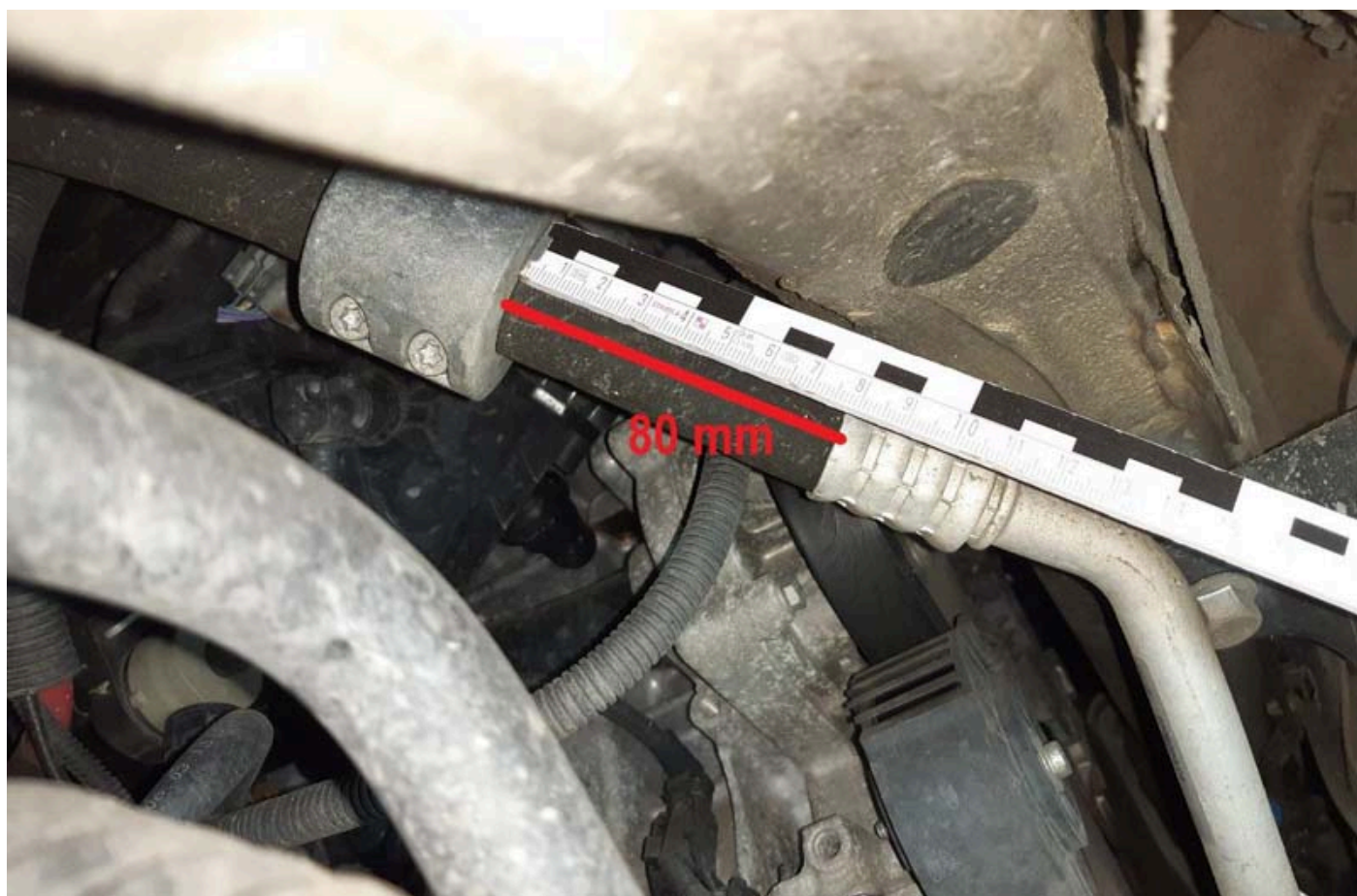
Figura 1: Ammortizzatore di vibrazioni per il montaggio a posteriori
