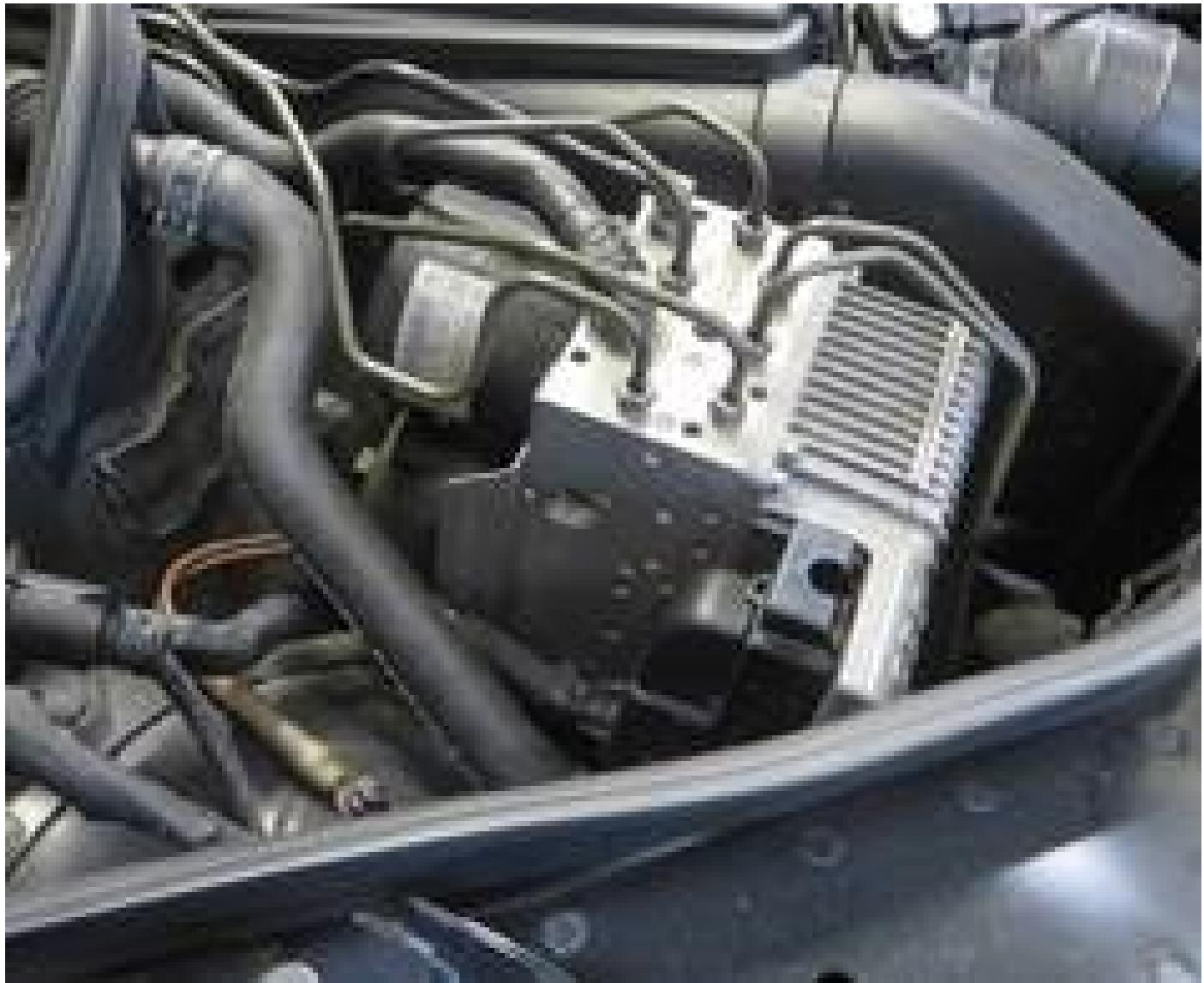
**Se viene registrato un determinato valore di numeri di frenate, viene raggiunto il cosiddetto limite di servizio e l'unità idraulica deve essere sostituita.**
